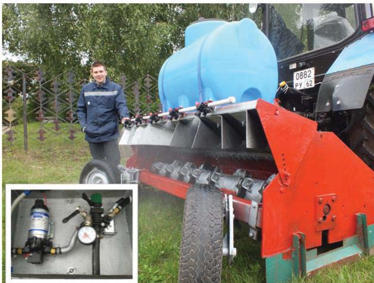
Рисунок 2 – Форсуночная рампа и регулятор давления комплекса для дифференцированного внесения рабочего раствора
